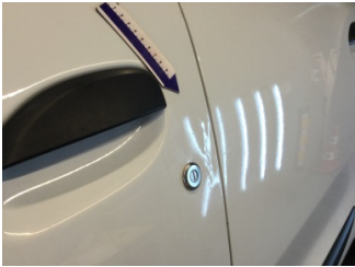
Kapı, sol ön, Kapı, sol ön > Ezik
