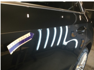
Kapı, sol arka, Kapı, sol arka > Ezic
