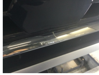
İlave parçalar, ön, Ön panjur > Çatlak
