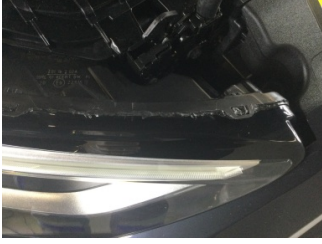
Farlar, Far, sağ > Standart Dışı Onarım
