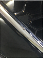
İlave parçalar, ön, Ön panjur > Çatlak
