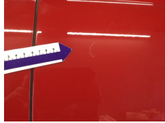
Kapı, sol arka, Kapı, sol arka > Çizik
